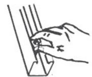
Una vuelta de 90 grados coloca las ranuras estriadas en la tuerca con los bordes de sujeción del canal.
